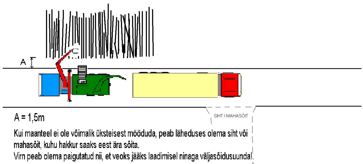
Joonis 1. Hakkimine, kui hakkur asub konteinerveoki taga
